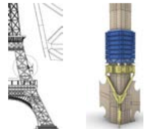
L'accrochage des anneaux sur la tour Eiffel - position des anneaux à 85 m de haut - ancrage d'un câble avec ses étriers
