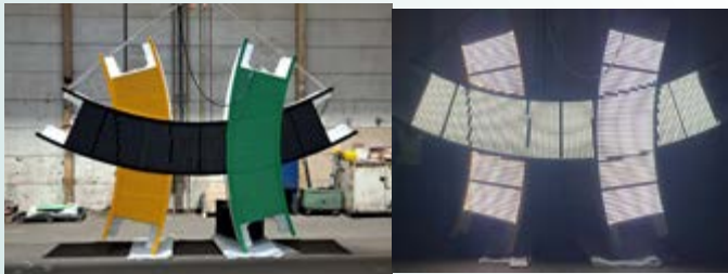
Le prototype des anneaux qui a servi à la mise au point des perforations des tôles de façade
