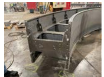
Découpage en 11 tronçons, transport 6 camions assemblage dans l'atelier
